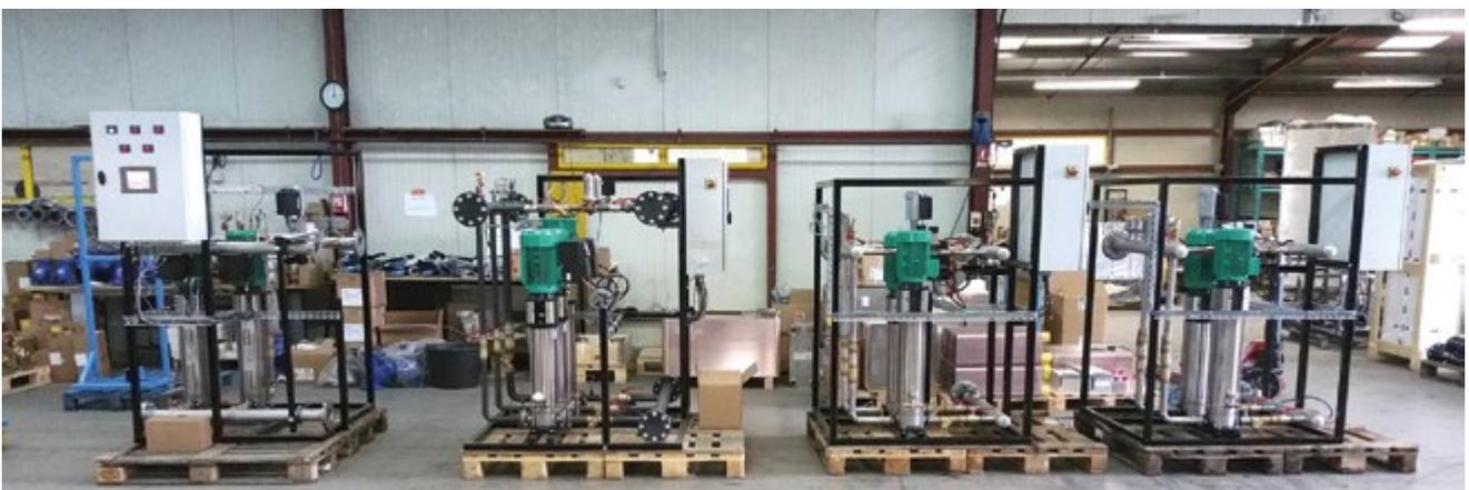
Configuration sur cahier des charges : pompes auto-adaptatives à variation de fréquence, dimensionnement décalé, régulation par automate, commande par écran tactile, contrôle à distance, communication par transferts de données montant - descendant, table d'échange Modbus avec adressage spécifique, pompes - 2, 3 ou plus - avec fonctionnement en cascade ou simultanément, secours, remplissage, permutation, fonctions de détection fuite, toute hauteur géométrique etc.
