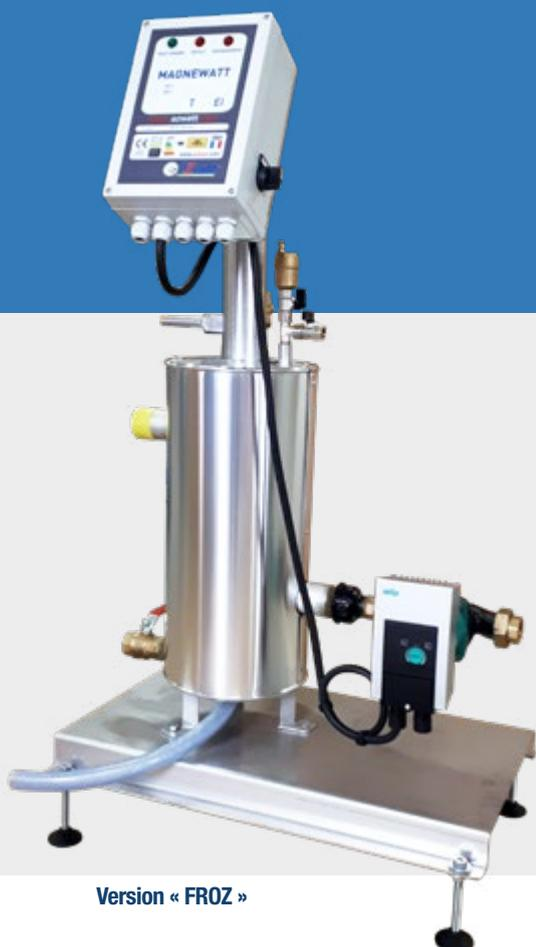
**Débit dans le filtre :** 3 à 62 m<sup>3</sup>/h - Eau de chauffage/eau glacée en version « FROZ \* » - Condensats - T° max. : 100 °C - P° max. : 10 bar.
