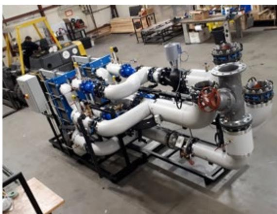
Chaleur ou froid, puissance de 30 kW à 10 000 kW, PN40, double échangeur, régulation, auto-adaptation aux différentiels de pression, toute régulation, communication GTC-GTB, P20b, PN40, encombrement et décomposition suivant contrainte local technique et accessibilité etc.
